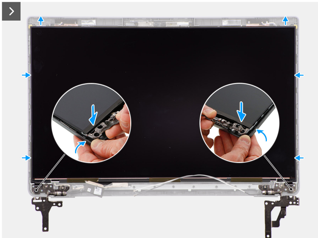
Abbildung 64. Einbauen des Bildschirms
