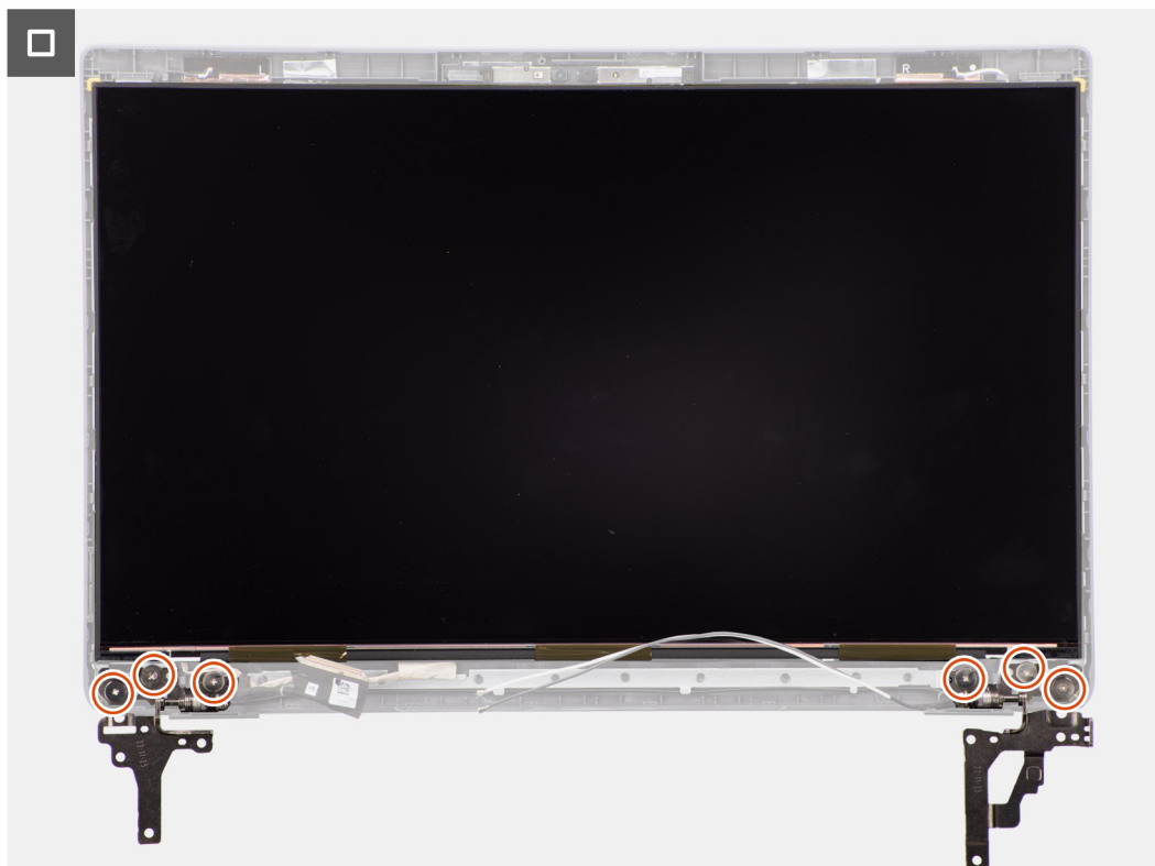
Abbildung 65. Einbauen des Bildschirms
