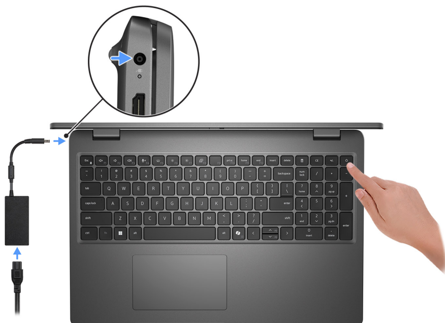
Abbildung 1. Schließen Sie das Netzteil an und drücken Sie den Betriebsschalter.
